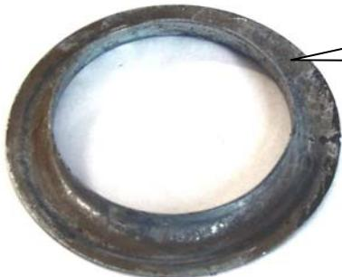
Federunterlage, welche serienmäßig in der Achse eingelegt ist, muss entfernt werden.
