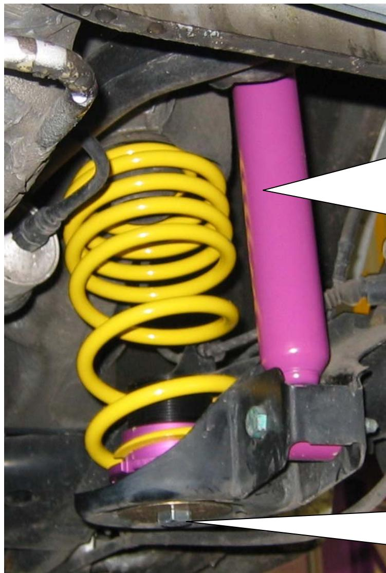
Sofern im Lieferumfang keine Anschlagpuffer enthalten sind, werden die serienmäßige Anschlagpuffer in ungekürzter Ausführung weiterverwendet. Diese müssen sich in einem einwandfreiem Zustand befinden und sind ggf. zu erneuern.
