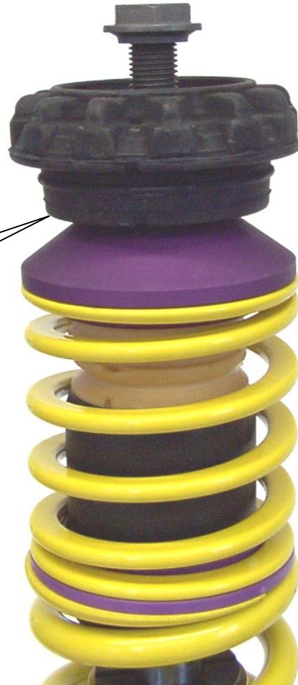
Das Original Domlager, wie im Bild dargestellt, aufsetzen und mit der Original Befestigungsmutter verschrauben 50 Nm. Zum Befestigen des Federbeins im Fahrzeug verwenden Sie bitte die mitgelieferte Stoppmutter. Das Anzugsdrehmoment beträgt 50 Nm. Den Einbau des Federbeins in das Fahrzeug, sowie die Anzugsdrehmomente der Federbeinbefestigung, entnehmen Sie bitte den Unterlagen des Fahrzeugherstellers.
